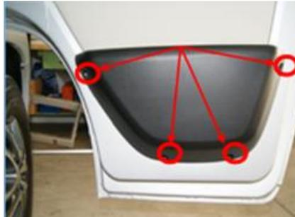
Um den Türsafe einbauen zu können, muss die Türablage entfernt werden. Hierzu müssen die 4 Torx Schrauben ausgedreht werden.
