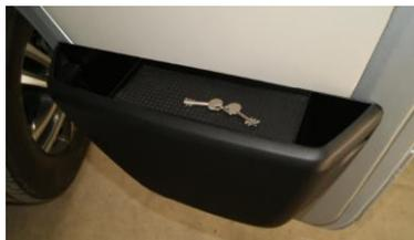
Der Safe wird an den Original-Schraubpunkten zusammen mit der Türverkleidung angeschraubt.
